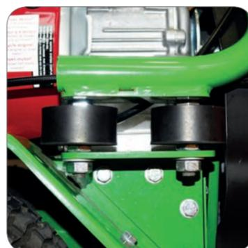
Schwingungsge-dämpfter Lenkholm durch Dämpferelemente
