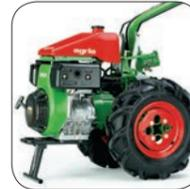
Ein Stützfuß erleichtert das Abstellen der Maschine ohne Anbaugerät und einen Gerätewechsel
