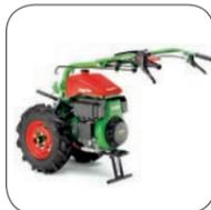
Maschine mit um 180° gedrehtem Lenkholm
