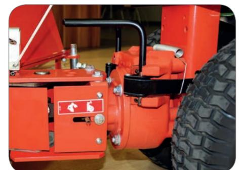
Bei Anbau-Kehrmaschine: 2-Gang-Besenantrieb zur Wahl der passenden Drehzahl
